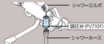
※水圧が0.3MPa以上の場合、水圧によりシャワー板がはずれるおそれがありますので、調圧弁 (PV710F) をご使用ください。
